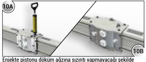
10A Enjektte pistonu döküm ağzına sızıntı yapmayacağı şekilde takılıp kol yardımıyla "Resin 4" malzeme ek içine enjekte edilir. Enjektte işlemi tamamlandığında plastik kapak kapatılır ve montaj işlemi sonlandırılır.
