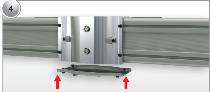
Ek kapağı, blok eki hizalamak için takılır ve cıvatalar çok güçlü olmayacak şekilde sıkılır.
